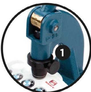
Para colocar los troqueles, debemos fijarlos a la parte móvil de la **C-25**. Afloje un poco la rosca (1), e introduzca el troquel y apriételo hasta que quede sujeto.
